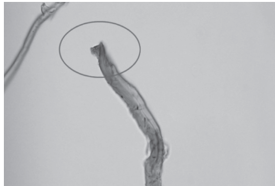
圖 7 纖維端部受損
