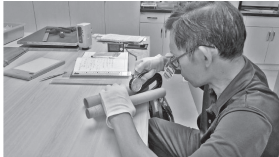
以厚度計測紙張厚度
