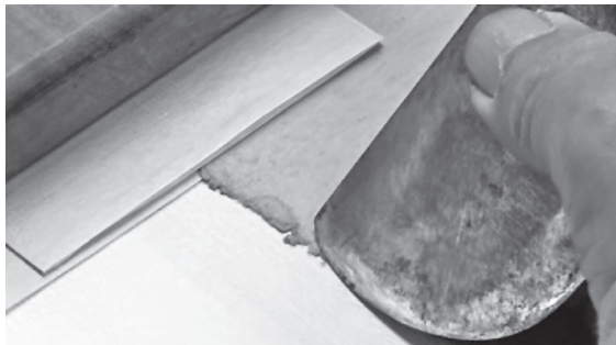
刮薄地腳處紙張厚薄不勻處
