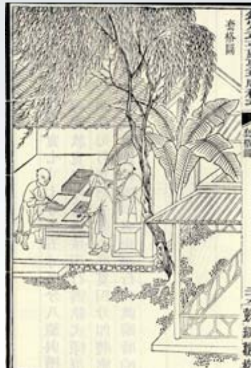
圖三十：木活字印書工序圖之七 套格圖
