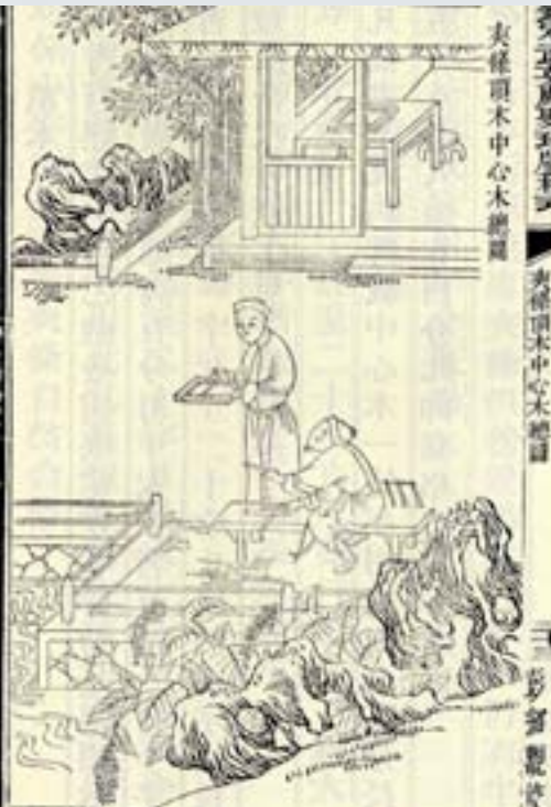
圖二十八：木活字印書工序圖之五 夾條頂木中心木總圖
