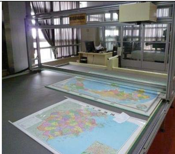
圖 15 浙江大學自行研發之大尺寸掃描機台(上方為移動式數位掃描鏡頭)
