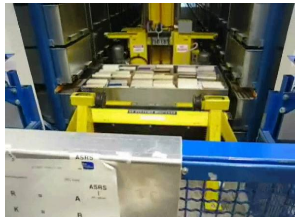
機械手臂將盛有被調閱圖書的儲存盒從積層櫃中取出
